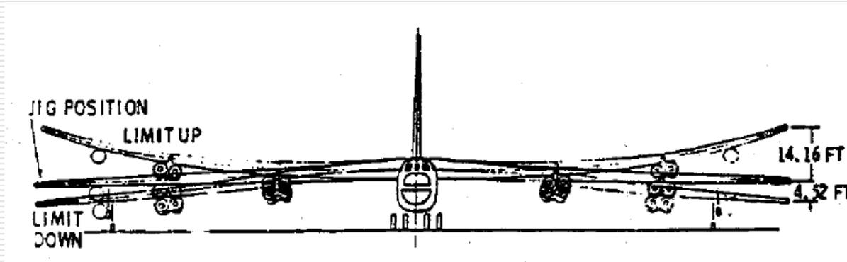
Deflexão das asas de aeronaves em vôo em função do carregamento aerodinâmico.
